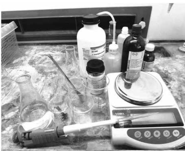
図 2: PNIPAAm ゲルの作成に使用した試薬と器
