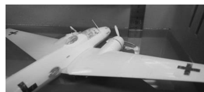
図6 プラモデルから機体の体積を求める実験
