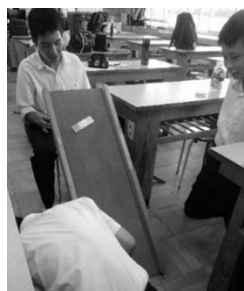
図5 摩擦角を求める実験 (左)と模式図(右)
