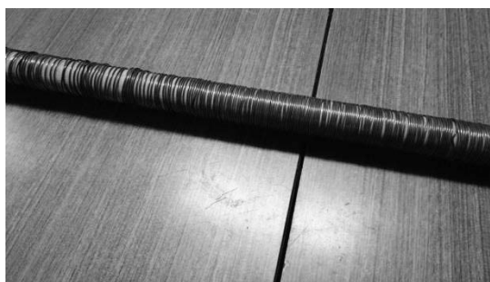
写真1 銅線を巻きつける
