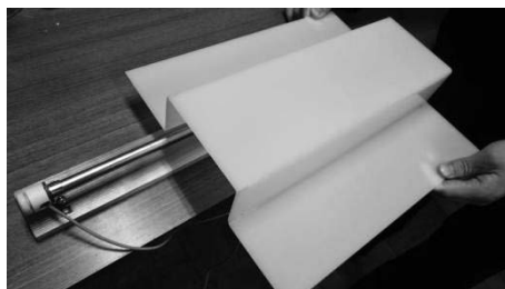
写真2 アクリルヒーターで曲げる
