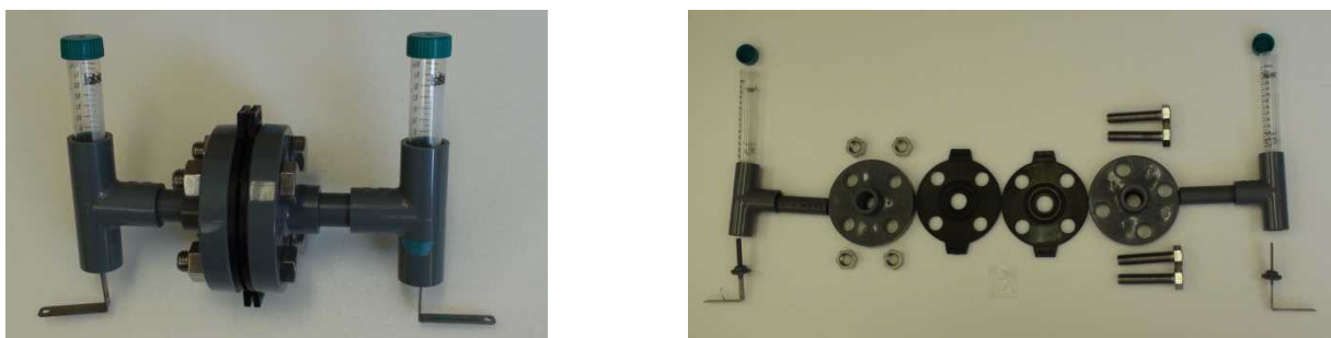
Fig.1 電解装置 (左) と電解装置に用いた部品 (右) .
