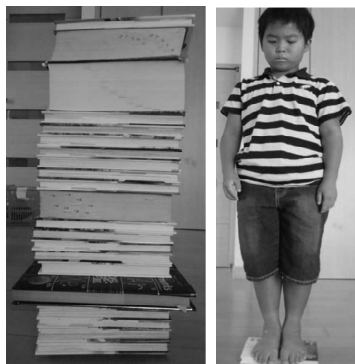
図10 工作用紙で作製したハニカム構造 左：沢山の本を積んでも潰れない様子 右：弟が乗っても潰れない様子
