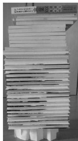
図11 コピー用紙で作製したハニカム構造の強度（六角柱6つ配置）
