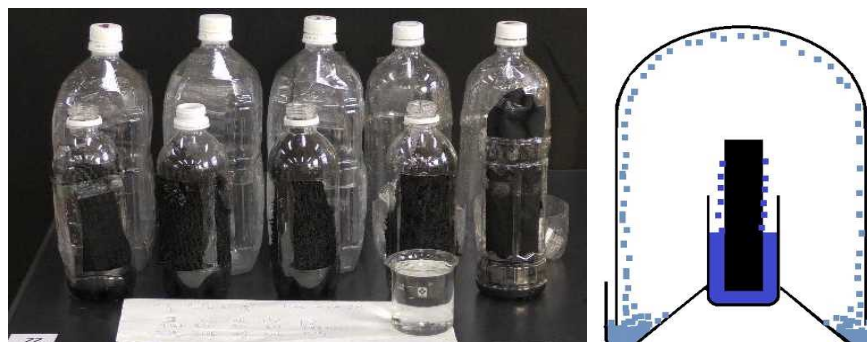
写真3 内側ペットボトル(手前)と外側ペットボトル(向こう側) 図1 装置の内部構造 3: 500mL のペットボトルを 1.5~2.0L ペットボトル内に入れ、外側のペットボトルの継ぎ目を透明テープで密閉する。
