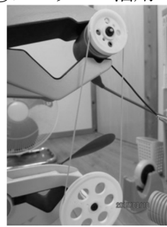
回転数を2倍にして、トルクを2分の1にする。
