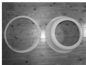
ディフューザ部分が長い「風レンズ」(右)と ディフューザ部分が短い「風レンズ」(左)
