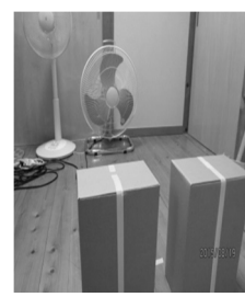
建物に見立てたダンボールで隙間をつくり、「ビル風」をつくる。
