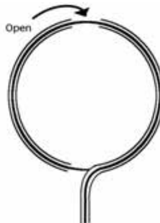
〈図2〉ループアンテナの構造
