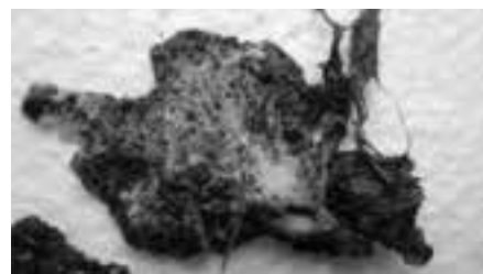
図 2 加熱重合直後のポリ乳酸 左から触媒 1 滴、2 滴、3 滴 図 3 土に埋めて 4 週間後のポリ乳酸
