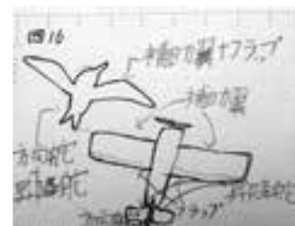
失速とは、主翼が速度を失い急に抵抗が増える現象。他にも機体を傾けて旋回する時や急下降から急上昇して大きな負荷がかかった時などにも起こる。
