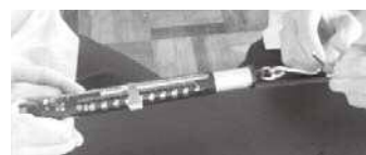
図 8. 引っ張り強度測定方法
