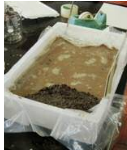
完成した津波発生装置
