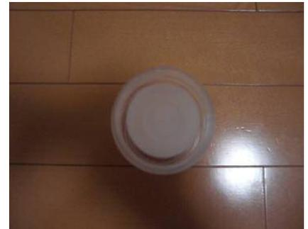
容器 A と容器 B をそれぞれ転がし転がる速さや様子を比べる。容器 A はフィルムケースに水を入れることで質量を回転軸の中心側にし、容器 B は容器に水を入れることで質量を回転軸の外側にした。
