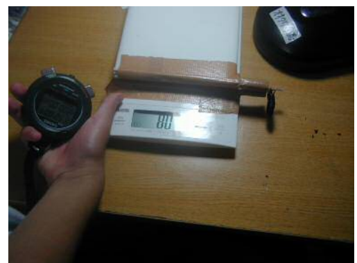
メス用に鉄の細い棒で幅をせまくした。また、すべらないように布テープを巻いた。
