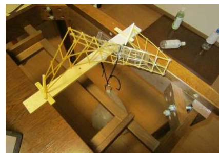
いびつな形のため破壊した円弧180度の上路式アーチ橋
