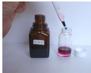
② EBT 溶液を 1 滴を加える。(赤くなる)
