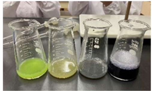
Fig. 2 今回の実験の滴定による色の変化と終点
