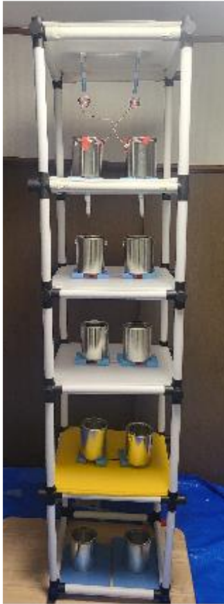
写真7 5段のケルビン水滴発電機
