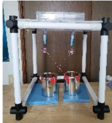
写真2 改良型ケルビン水滴発電機
