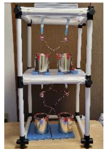
写真4 2段ケルビン水滴発電機
