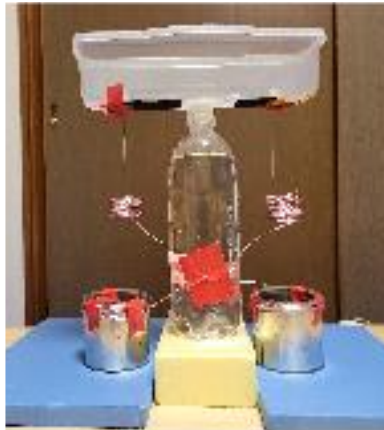
写真1 旧型ケルビン水滴発電機
