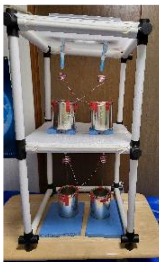
写真5 上段と下段のコイルが分離した2段ケルビン水滴発電機
