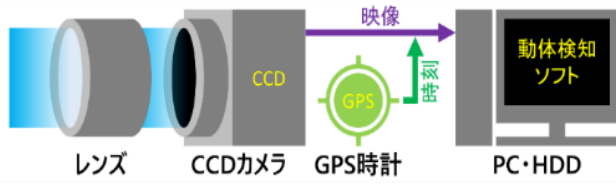
図2-1 TLE観測システムの模式図
