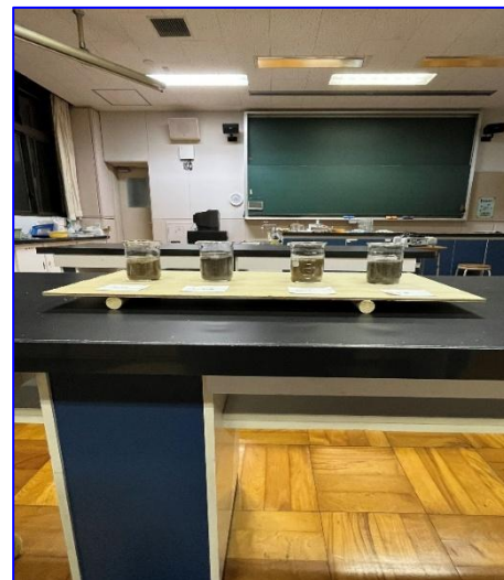
写真8 板の下に「ころ」を置く
