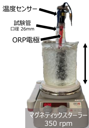
Fig.3 「完全冷却」による BR 反応の測定装置
