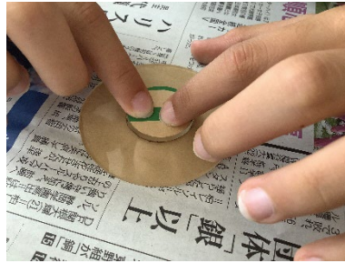
亚克力板を接着する
