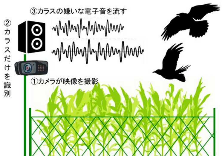
図5. 機械学習を活用したカラス撃退装置のしくみ.
