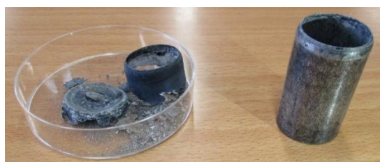
図7 電池の内部粉末 (左:未使用、右:24時間放電後)
