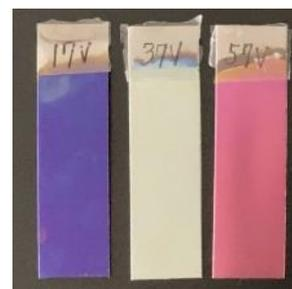
写真5 実際に陽極酸化したチタン板
