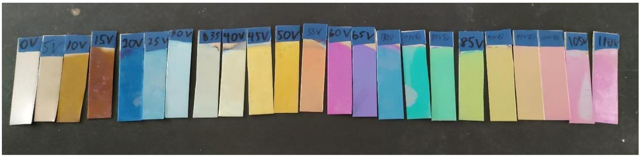
写真4 陽極酸化させたチタン板 (左から0V、5V、10V…と5V間隔で並んでいる)
