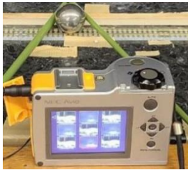
図 10 サーモグラフィカメラを設置した時の様子
