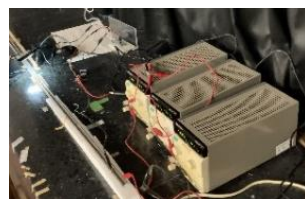
図 2：センサ・斜面・定電流電源装置の様子
