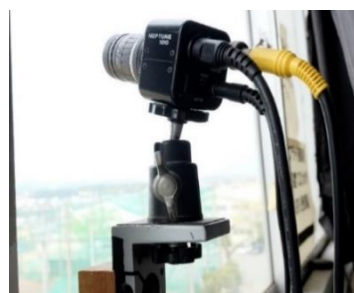
図2-2 高感度CCDカメラ (WAT-100N)
