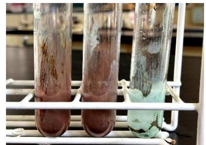
図8 気体を封入した銅鏡 (左から N<sub>2</sub>、O<sub>2</sub>、CO<sub>2</sub>)
