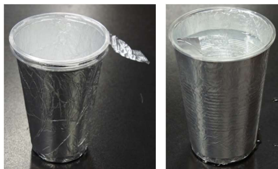
図 1 静電気コップ(左:アルミ箔 2 層 右:水とアルミ箔)
