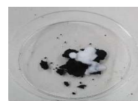
図 19 水酸化亜鉛を内部粉末に混ぜた (左：未使用 右：24 時間放電後)
