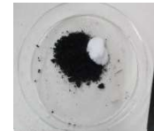
図 19 水酸化亜鉛を内部粉末に混ぜた (左：未使用 右：24 時間放電後)
