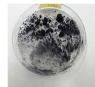
図 20 数日乾燥させた内部粉末の様子 (左：未使用 右：24 時間放電後)
