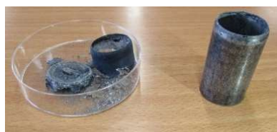
図 10 亜鉛缶の様子 (左:40 時間放電、右:新品)
