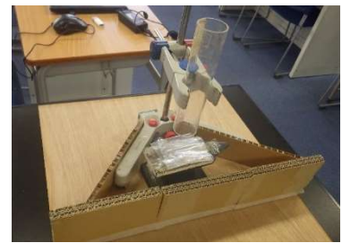
図 18 鉄球落下法装置
