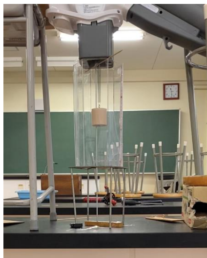
図2 実験装置 全体像 〔上部・・・送風機, 中部・・・風洞部分, 下部・・・三脚〕
