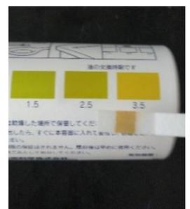
図10 AV試験紙による酸化の確認
