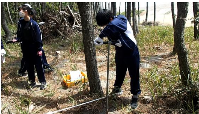
図 19.ハンドオーガーによる掘削の様子
