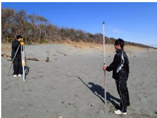
図5.オートレベルによる水準測量
