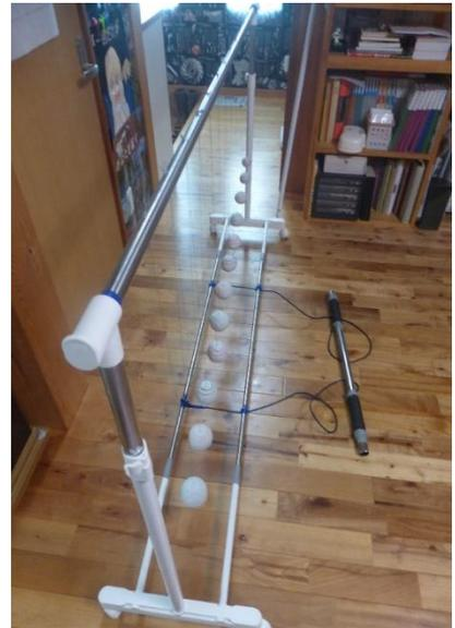
スタート地点から印をつけたところまで装置を動かし、動かした距離、動かしたスピード、加速が均一だったかどうか、石で装置を止めたかどうかを確認しながら、1個の印ごとに20回ずつ実験をした。
