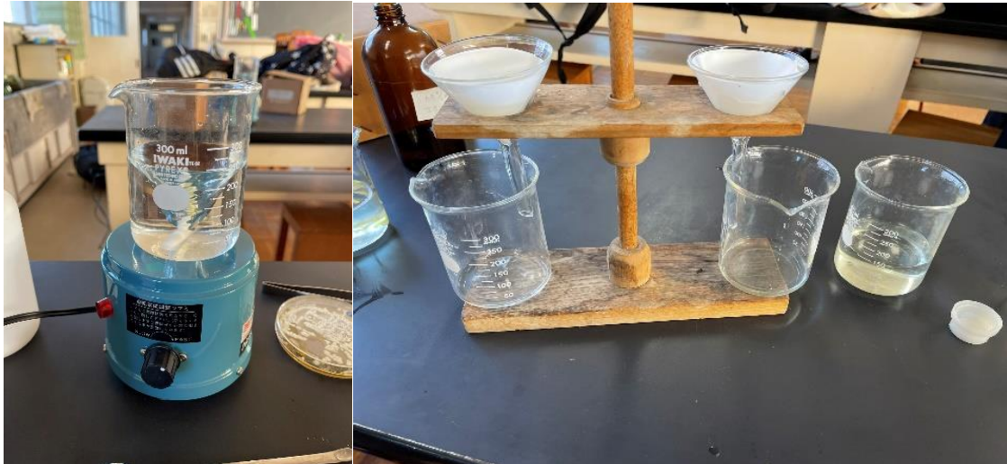
(左、攪拌機を用いて攪拌を行っているところ 右、攪拌後の液体の濾過を行っているところ)
