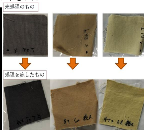
写真4 実験3 結果 (綿) 左から鉄、銅、アルミニウム
