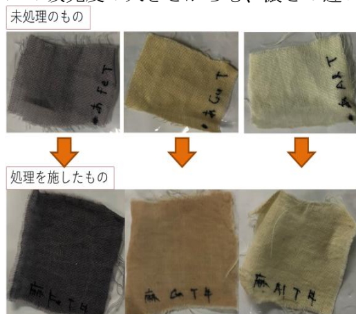
写真3 実験3 結果 (麻) 左から鉄、銅、アルミニウム
