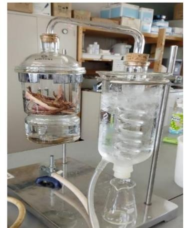
(写真 2) 水蒸気蒸留器
