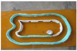
【実験B1】川のカーブの内側と外側の流速を調べる。
