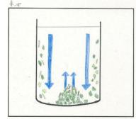
【実験B8】水深による回転流の速さを測定する。
