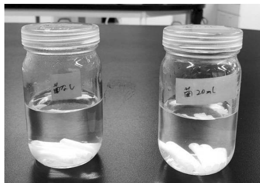
図1 方法(サ)ストロー分解が進んだ後CO 2 量の比較をする装置
