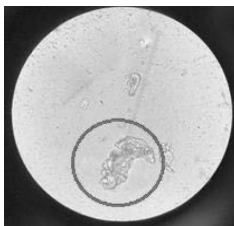
図3 対象実験(菌なし) 平均的な破片の大きさ 85 μm
