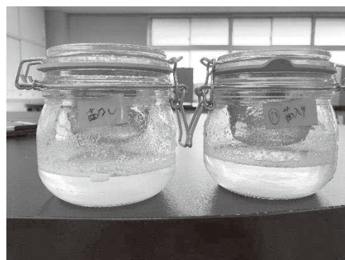
図5 分解で生じるCO 2 をNaOH(aq)で受け取る装置
