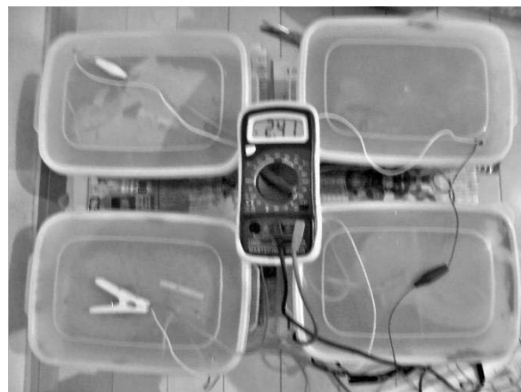
(写真10) 直列つなぎの電圧
