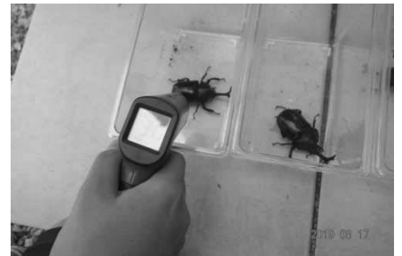
写真3 放射温度計でカブトムシの体温を計測している様子
