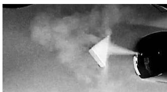
**方法** 去年の実験で一番後方に流れていたのが、逆三角形だったので外側・真ん中(5.5cm)・内側にケント紙で作った逆三角の突起をつける。
