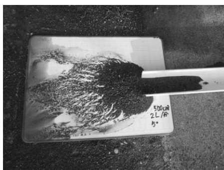
〈土砂を流した様子〉
