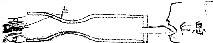
ビニールホースシンセサイザーの構造
