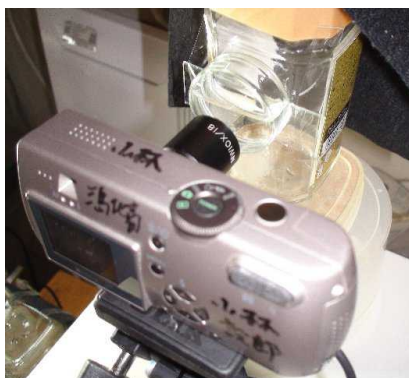
写真 3 記録に使ったカメラと自作水槽
