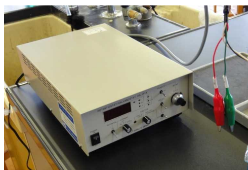
測定機器 ポテンシostat 北斗電工 HA-151A
