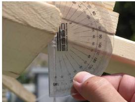
発射台の傾きは、写真のように発射台に糸つきの重りをぶら下げて、この糸と発射台の角度を分度器で測定した。このときの角度は 70 度だったため、発射台の上向きの角度は、90 度から測定した値を差し引いた 20 度と分かった。
