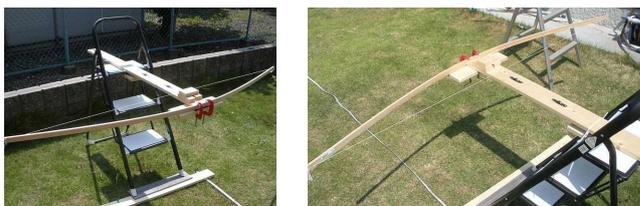
②引く力を一定にするため、写真のように滑車を使うことで、バケツに入れたペットボトルの重量で引くようにした。
