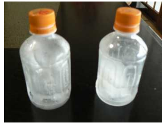
左 -1^{\circ}\text{C} の氷 右 -15^{\circ}\text{C} の氷
