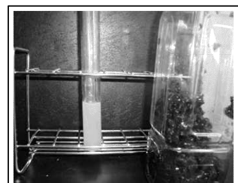
図 7 イシクラゲによる石灰水の白濁
